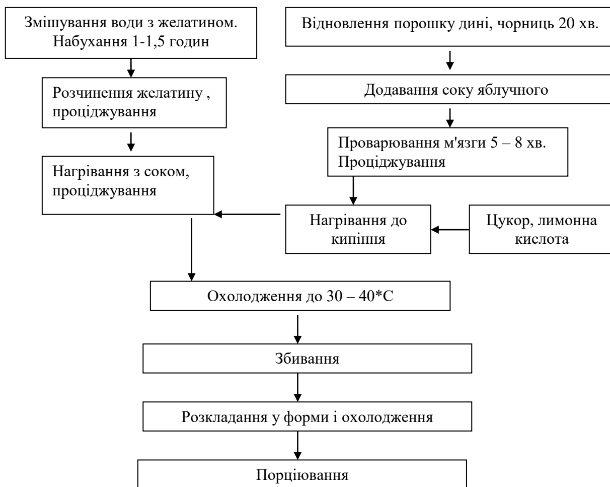
Рис. 3.2 Технологічна схема приготування мусу «Фрутелла»
